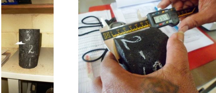
Fig. 22 Bepaling afmetingen van de Marshalltabletten
