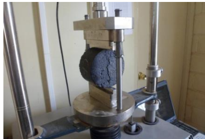
Fig.28 Plaatsing van de Marshalltabletten in waterbad op temperatuur van 25°C en drukken van de tabletten
