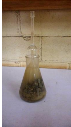
Fig. 17b Pycnometerfles + materiaal+ water
