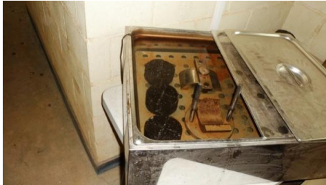
Fig.25 Plaatsing van de Marshalltabletten in een waterbad met een temperatuur van 60 \pm 1 °C en drukken van de tabletten
