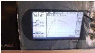
Fig. 26 Marshalldiagramafbeelding op de monitor van de drukbank
