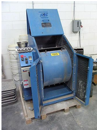
Fig. 13 Het Los Angeles Abrasiontestapparaat
