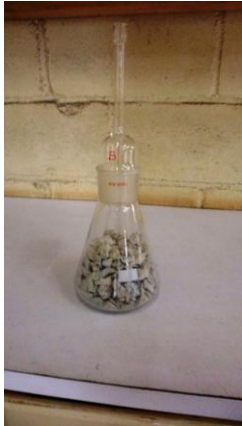
Fig. 17a Pycnometerfles met materiaal
