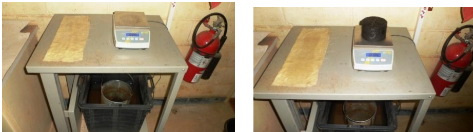
Fig. 24 Weging Marshalltablet, onder en boven water (bulk density met ingesloten lucht)
