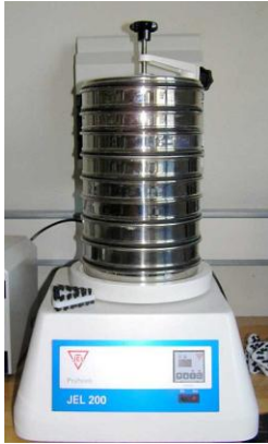
Fig. 16 Zeefset op mechanische shaker
