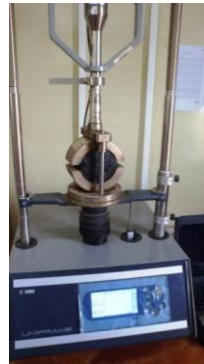
Fig.25 Plaatsing van de Marshalltabletten in een waterbad met een temperatuur van 60 \pm 1 °C en drukken van de tabletten
