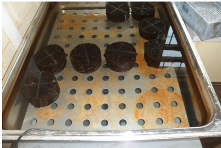
Fig.28 Plaatsing van de Marshalltabletten in waterbad op temperatuur van 25°C en drukken van de tabletten
